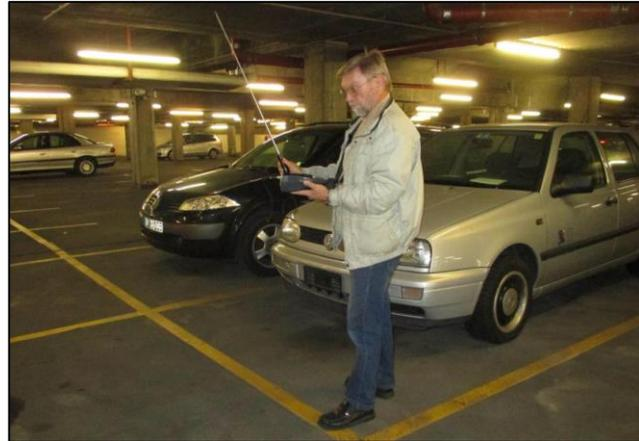
Bild 3: Kohlenmonoxid(CO)-Messung in einer Tiefgarage
