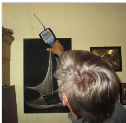
Bild 2: VOC-Messung mit Fotoionisationsdetektor
